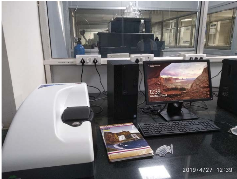
टीजी-डीटीए/डीएससी (सेटारेम इंस्ट्रुमेंटेशन फ्रांस, लेबिसस ईवीओ 1150°C, DSC131 ईवीओ एनालाइज़र)
