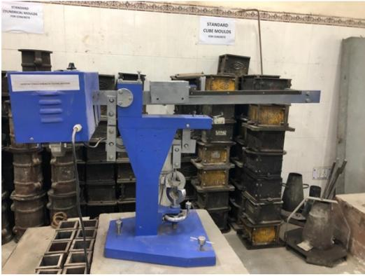
BRIQUETTE TENSILE TESTING
